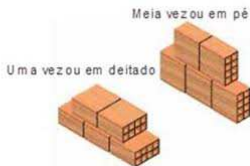
Figura 1: Detalhe assentamento de 1 vez.
