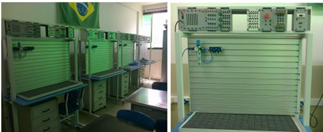
Fig. AIV-2 - Sistema de treinamento em pneumática e eletropneumática.
