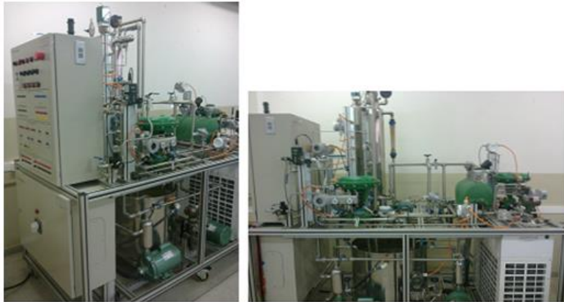
Fig. AIV-3 - Planta didática para estudo de Controle de Processos, Instrumentação e Redes Industriais.
